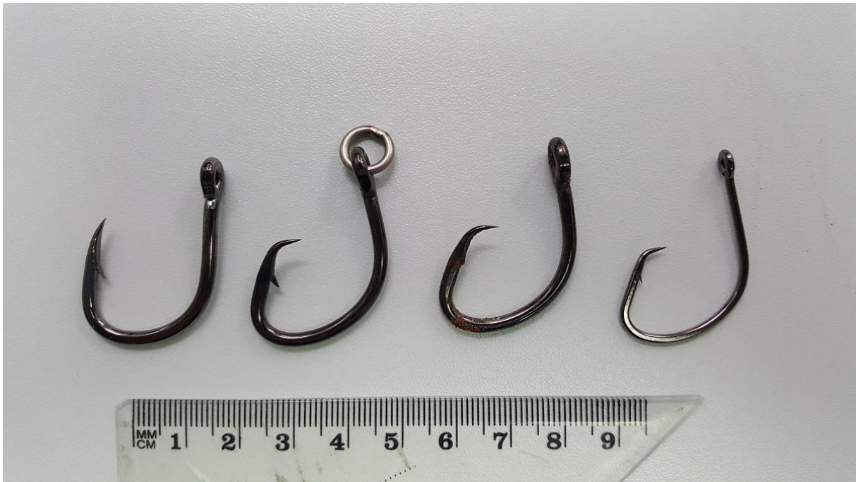
Slika 9. Udice korištene u eksperimentu, (s lijeva na desno) ravna udica J – oblika s bodljom ( J ), kružna udica s bodljom C-oblika vezana preko prstena ( Cp ), kružna udica bez bodlje ( Cbb ), kružna udica s bodljom bez prstena -natjecateljska ( Cn ).
