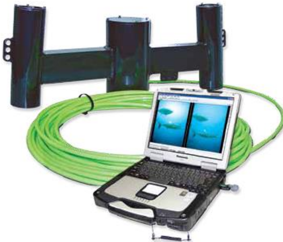
Slika 3. Glavne komponente sustava stereoskopske kamere AQ1 SYSTEMS za procjenu broja i veličine ulovljenih tuna
